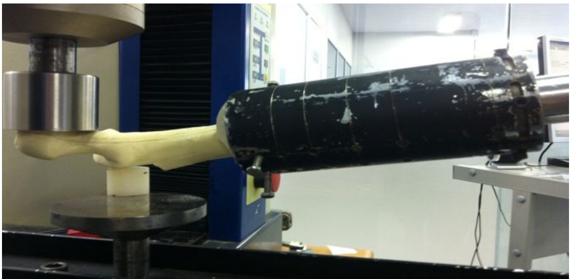
Figura 3. Corpo de prova após ensaio de compressão estático.(Autoria Própria)
